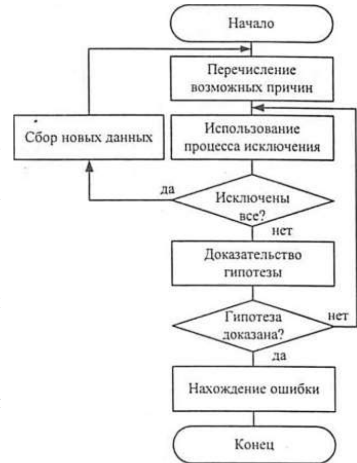
Рисунок 10.4 - Схема процесса отладки методом дедукции
