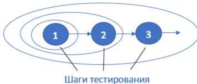
Рисунок 5.5 - Шаги тестирования вложенных циклов
