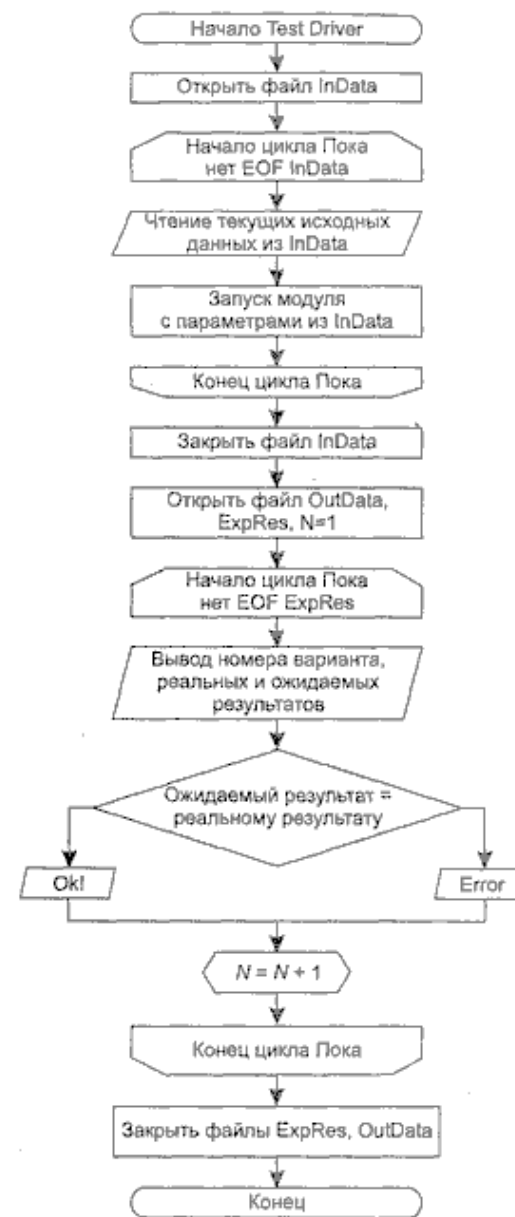
Рисунок 7.3 - Алгоритм работы драйвера тестирования
