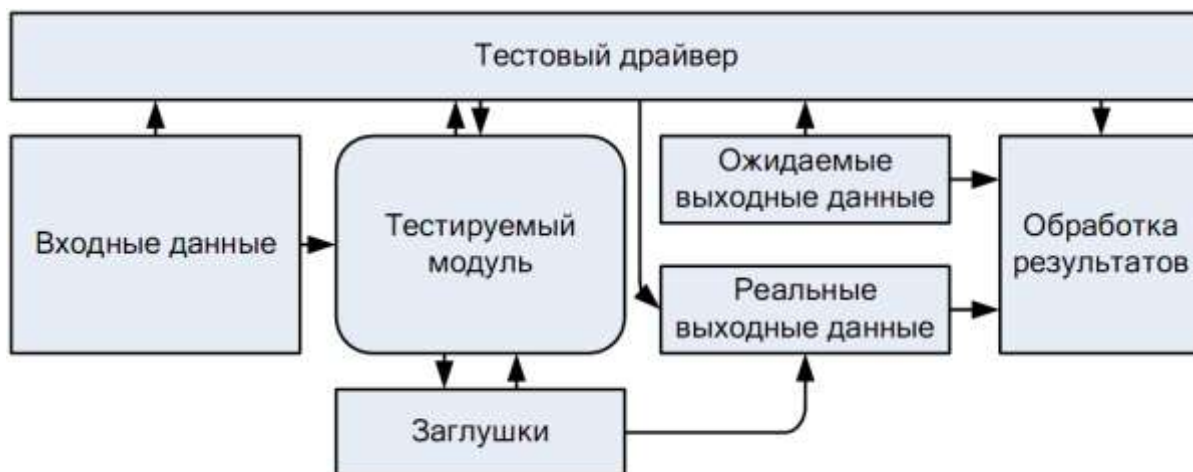
Рисунок 4.1 – Драйвер в обобщённой среде тестирования
