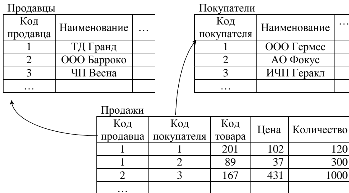
Рис. 7. Представление данных о продажах в реляционной модели данных. Стрелками показаны связи полей таблиц
