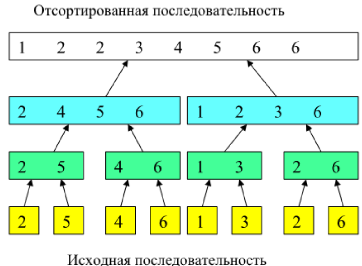
Рисунок 2.1 - Сортировка слиянием для массива A [5, 2, 4, 6, 1, 3, 2, 6]
