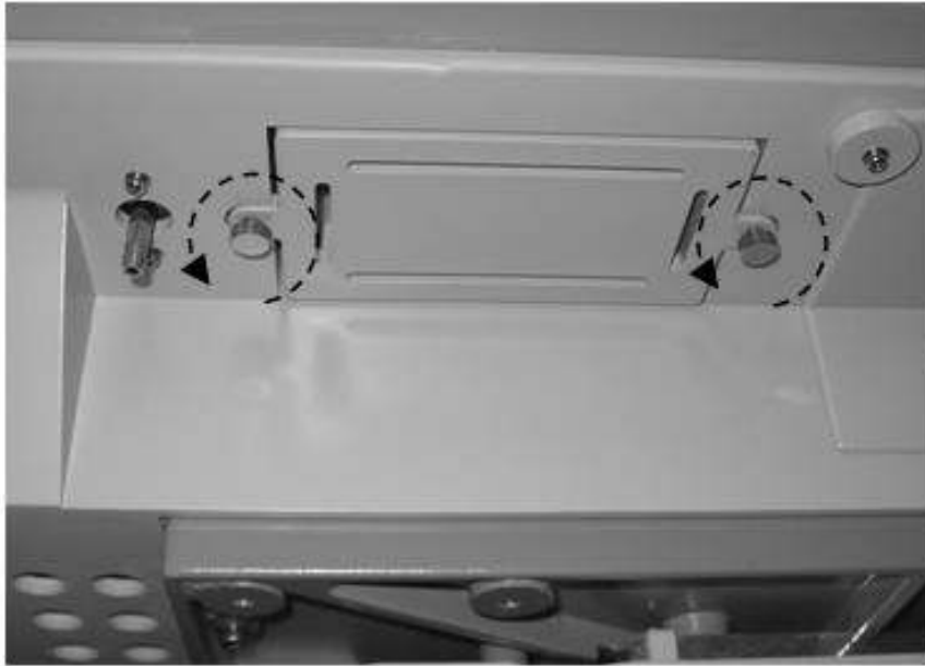
Suruburi caseta filtru
