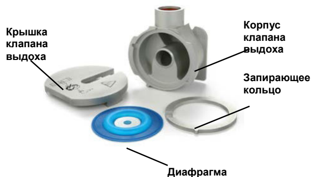
Рисунок 51: Клапан выдоха
