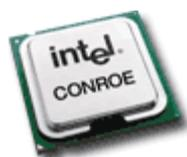
Микроархитектура Intel Core является многоядерной микропроцессорной архитектурой, представленной фирмой Intel в 2006 году. Она имеет несколько ядер и аппаратную поддержку виртуализации (Intel VT), а также поддерживает Intel 64 (64-битный режим) и SSE3 (дополнительный набор команд).
