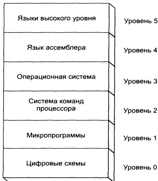
Рисунок 1.2 – Шестиуровневая модель виртуальных машин
