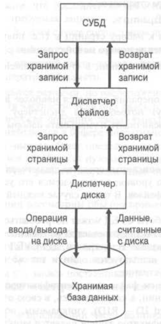
Рис. ГЛ. Общая схема взаимодействия СУБД, диспетчера файлов и диспетчера диска
