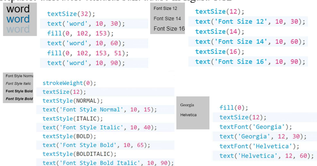
Figura 1.12 Exemple de utilizare a funcțiilor de lucru cu textul
