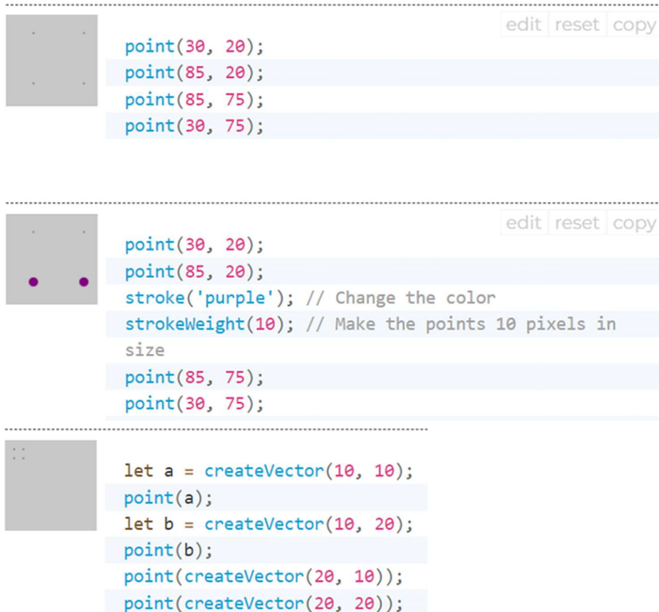
Figura 1.5. Exemple de program pentru funcția point
