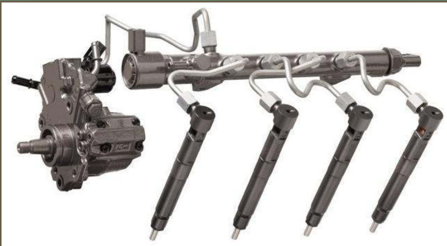
Sistemul de injecție cu rampă comună și injectoare piezoelectrice cu acționare directă. Sursa: Delphi
