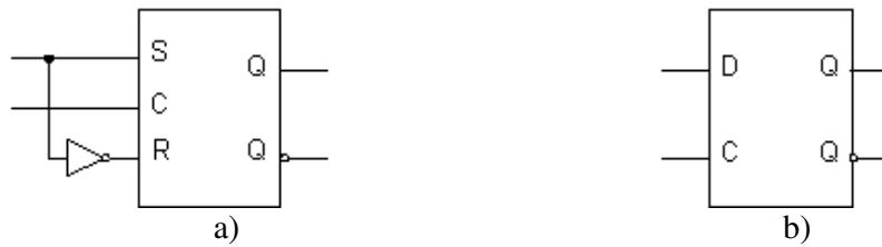
Fig. 3.3. Circuitul bistabil D sincron:
