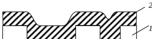
Рис. 10.5. Конформное осаждение плёнки на рельефную поверхность с исходно различным размером окон: 1 – исходный слой с окнами; 2 – осажденный слой
