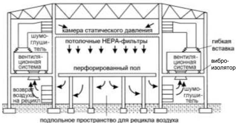
Рис. 3.1. Чистое помещение с вертикальным однонаправленным потоком воздуха
