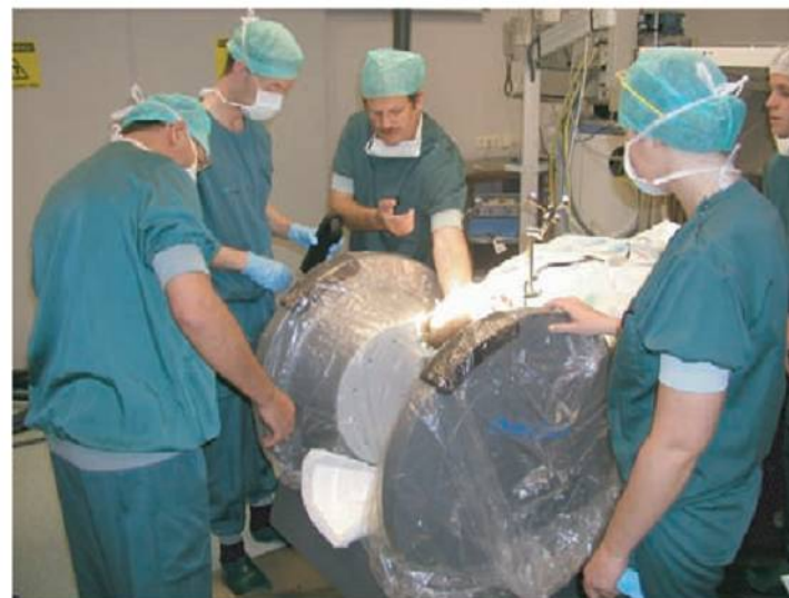
Fig. 3.5 Medtronic PoleStar® iMRI Navigation Suite, un sistem RM de ghidare-imagine intra-operativ, care funcționează la 0,15 T (pasul de gradient 25 mT / m), potrivit pentru o cameră de operare existentă. (Prin amabilitatea profesorului B. ter Haar Romeny, Maastricht AZ și TU Eindhoven.)
