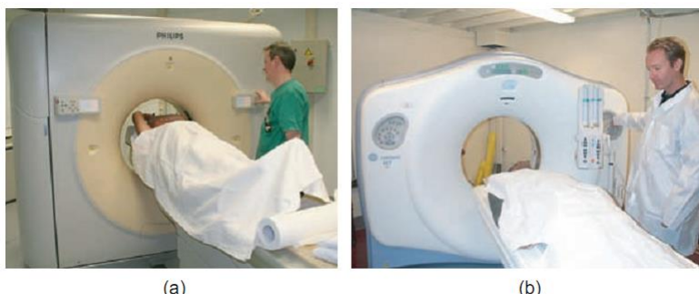
Fig. 3.26 Designul exterior al unui scanner multi-slice care nu este semnificativ diferent de scanner de singură felie. (a) Philips Brilliance CT cu 64-canale, cu detector de 64 de rânduri. (b) GE Lightspeed VCT cu detector de 64 de rânduri.
