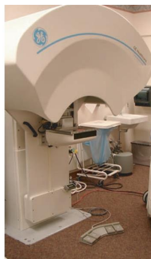
Fig. 3.25 Prototip de Tomosynthesis digitală a sânilor de generația a doua instalat la Universitatea din Michigan pentru cercetare clinică (Amabilitatea de GE Healthcare.)
