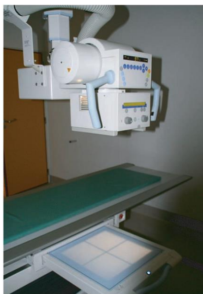
Fig. 2.11. În sisteme mai recente de raze X casetă și intensificatoare de imagine sunt înlocuite cu un detector ecran plat cu matrice activă. Această imagine prezintă un sistem Siemens, cu un detector mare de siliciu amorf cuplat la o placă-scintilator de CsI
