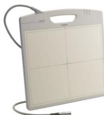
Fig. 2.11. În sisteme mai recente de raze X casetă și intensificatoare de imagine sunt înlocuite cu un detector ecran plat cu matrice activă. Această imagine prezintă un sistem Siemens, cu un detector mare de siliciu amorf cuplat la o placă-scintilator de CsI
