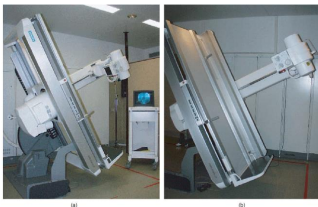
Fig. 2.10. Cameră radiografică multifuncțională. Masa poate fi înclinată în orice orientare. Atât un intensificator de imagine cât și o casetă cu fosfor depozitare sunt disponibile.
