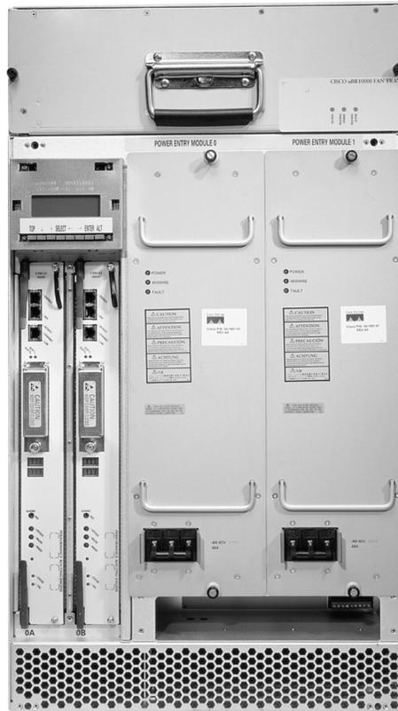
Рис. 2.16. Система CMTS серии Cisco uBR1001
