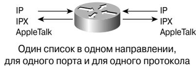
Рис. 22.13. Правила использования списков управления доступом
