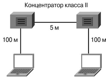
*Рис. 7.16. Диаметр коллизийного домена для концентраторов второго класса*
