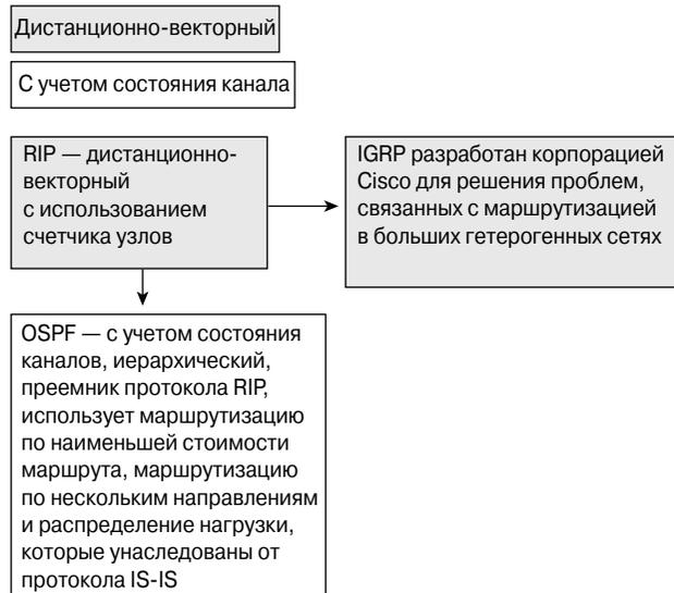
Рис. 10.25. Основные характеристики наиболее распространенных протоколов маршрутизации
