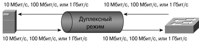
Рис. 8.6. Технология коммутации: дуплексный режим передачи данных
