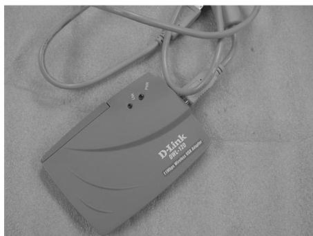
*Рис. 3.46. Внешний беспроводный сетевой адаптер с US-интерфейсом*
