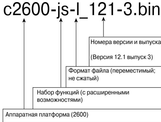
Рис. 16.3. Принятые корпорацией Cisco обозначения для имен файлов
