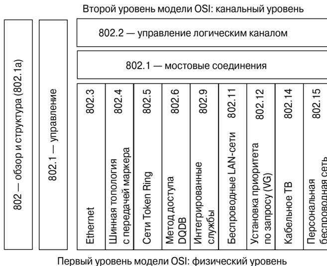
Рис. 6.2. Спецификации сетей LAN и эталонная модель OSI
