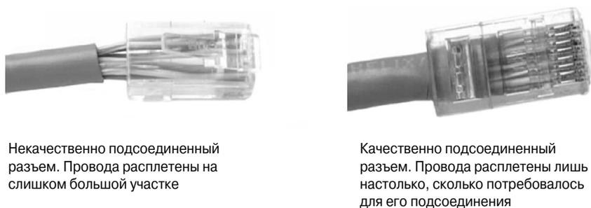
Рис. 4.12. Разъем, подверженный перекрестным наводкам
