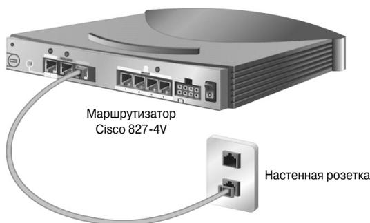
Рис. 5.33. Маршрутизатор Cisco 827-4V
