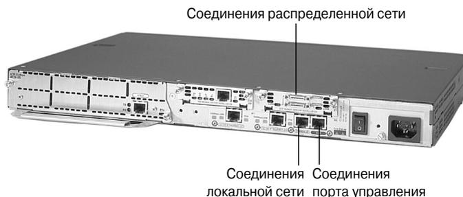
Рис. 12.16. Внешние разъемы маршрутизаторов
