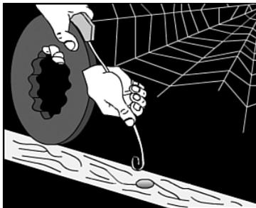
*Рис. А.32. Укладка кабеля с помощью проволоки*
