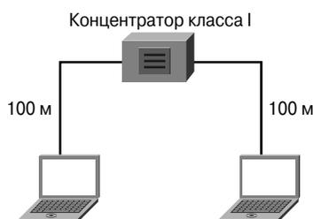
Рис. 7.15. Максимальный диаметр коллизийного домена при использовании концентратора первого класса
