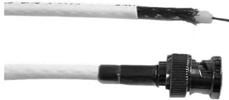
Рис. 7.6. Тонкий коаксиальный кабель и BNC-соединитель
