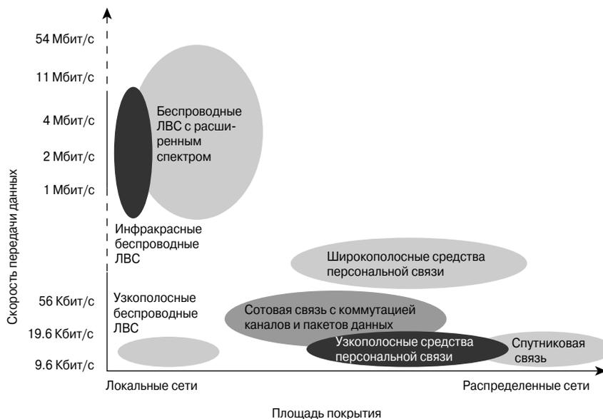
Рис. 3.38. Беспроводные сети передачи данных
