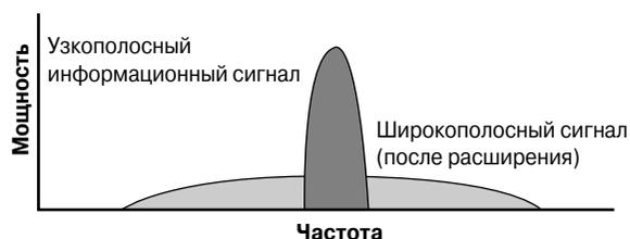
Рис. 3.42. Технология расширения спектра
