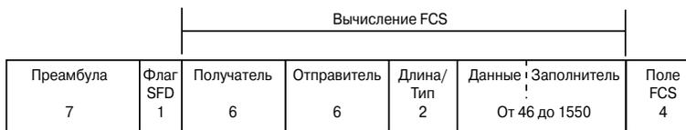
Рис. 6.7. Структура фрейма Ethernet спецификации 802.3 Института IEEE
