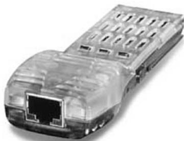
Рис. 5.4. Конвертер GBIC
