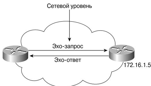
*Рис. 15.6. Проверка соединения при помощи команды ping*
