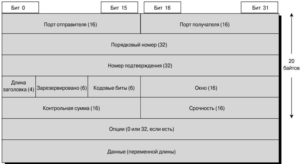
Рис. 21.4. Формат сегмента в протоколе TCP
