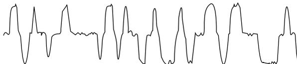
Рис. 7.12. Пример сигнала 100BASE-TX
