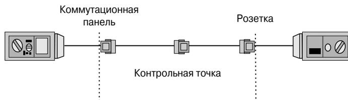
Рис. А.48. Тестирование постоянного канала
