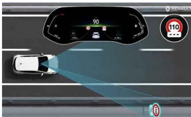
Figura 9 - Recunoașterea semnelor de circulație și a altor elemente de mediu.
