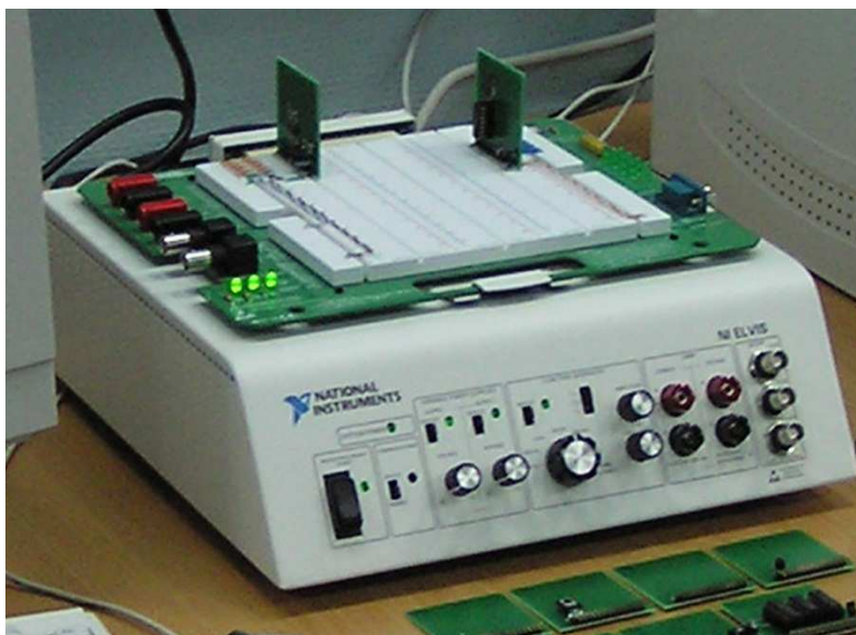
Рис.10. Внешний вид лабораторной станции NI ELVIS с установленными аналоговым и цифровым модулями
