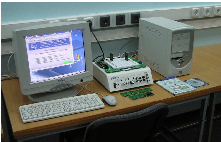
Рис. 12. Внешний вид станции NI ELVIS с блоками компьютера
