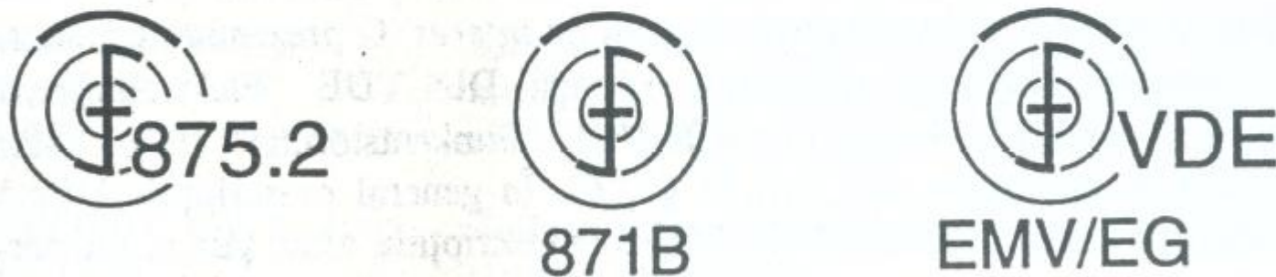
Fig.12.4. Marcaje DIN-VDE pentru indicarea protecției la perturbații. Cifre sau litere suplimentare permit identificarea normei de încercare valabile în fiecare caz, respectiv gradul de perturbații (marcajul din dreapta este în discuție).
