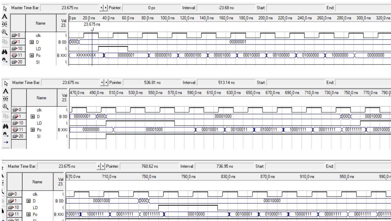
Proiectați un registru de deplasare pe 3 biți, activ pe frontul negativ al semnalului de ceas, cu resetare sincronă, încărcare paralelă, care efectuează operația de împărțire la 2.
