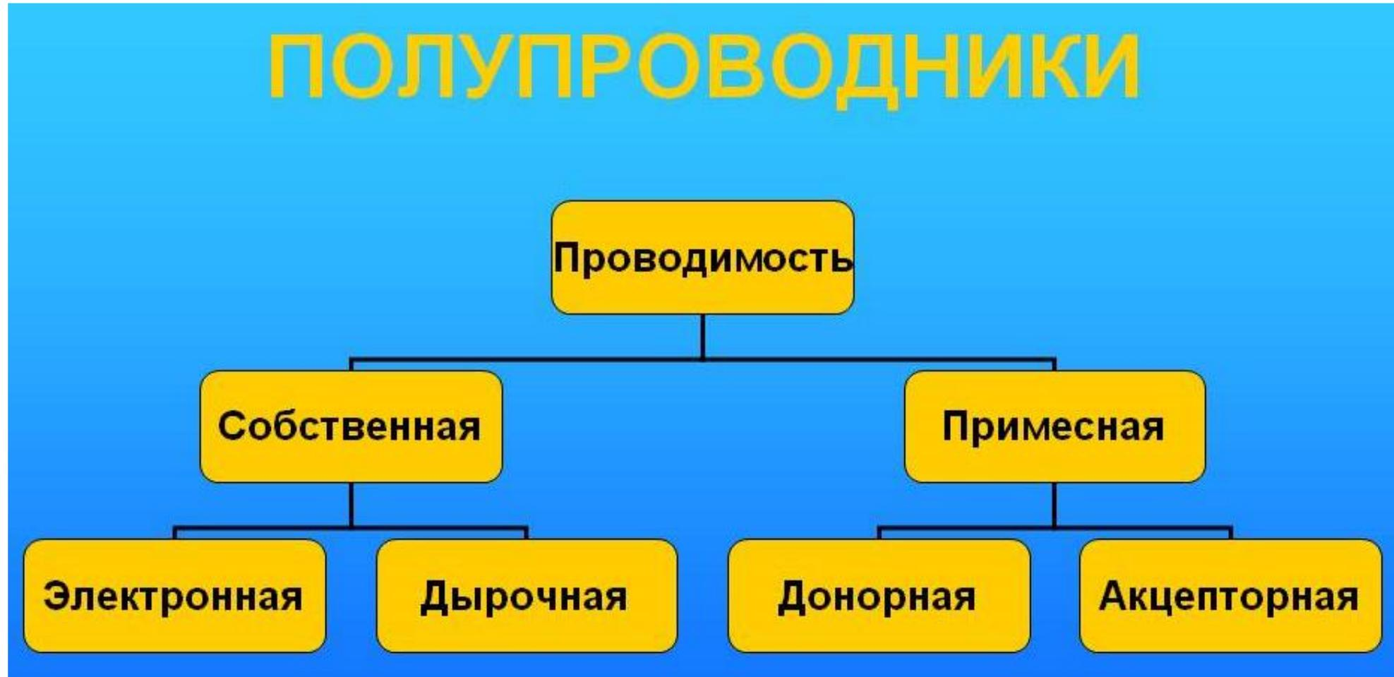
В качестве полупроводников наиболее часто используют германий (Ge), кремний (Si), арсенид галлия, селен, различные оксиды, нитриды и карбиды.
