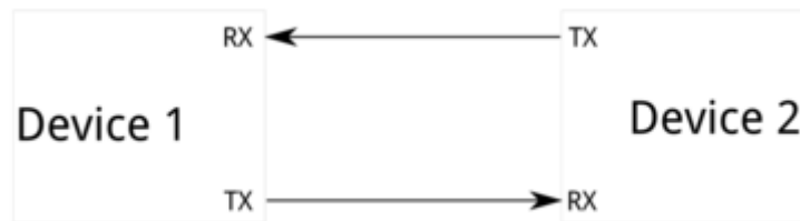
Figura 7.1 Comunicația serială între două dispozitive
