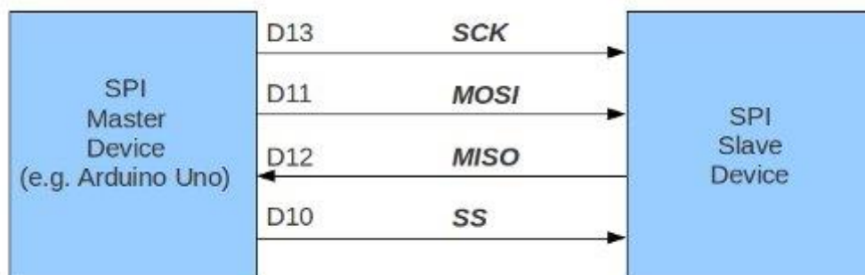
Figura 8.1 Comunicația SPI cu un singur circuit slave [12]
