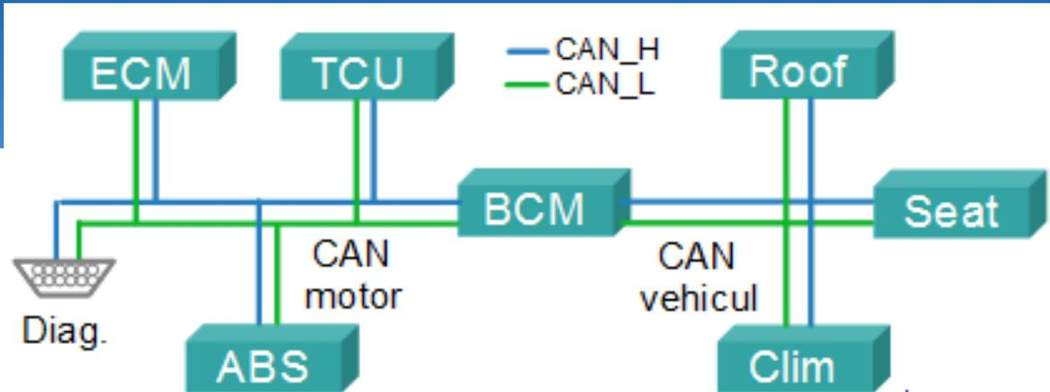
**ECM** (Engine Control Module) – calculatorul de injecție (motor)
