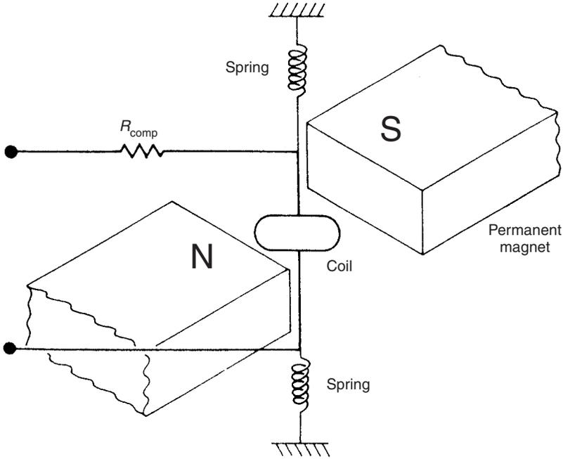
Fig. 3.2 Millivoltmeter.
