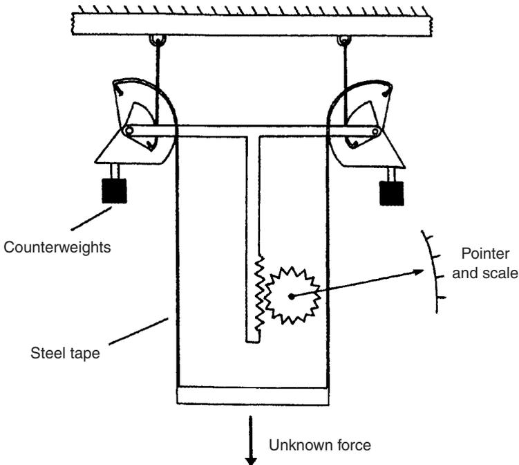
**Fig. 18.7** Pendulum scale.
