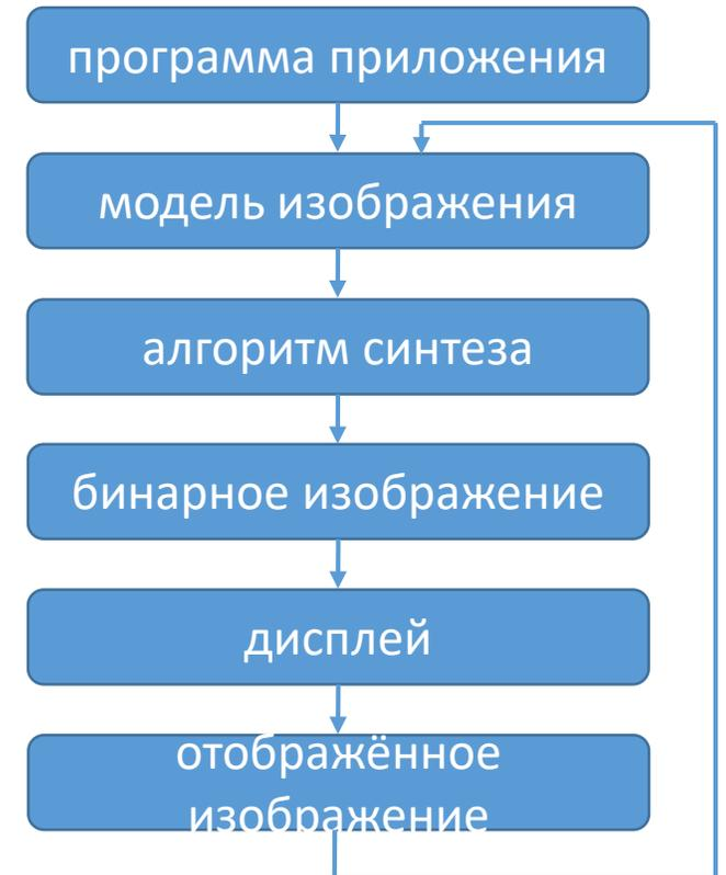
Рис. 1.1. Схема системы синтеза изображений
