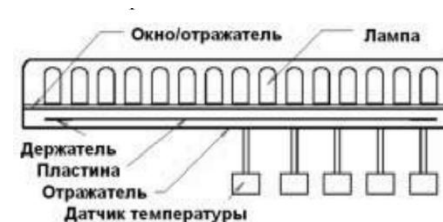
Fig 2. Instalație TTR cu dispunerea orizontală a filamentelor la lămpile cu halogen.
