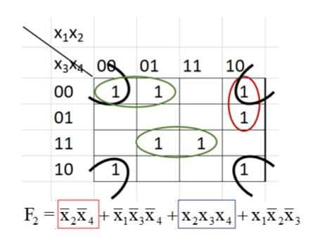
$$F_1 = \overline{x_2}\overline{x_4} + \overline{x_1}\overline{x_4} + \overline{x_2}x_3x_4 + \overline{x_1}\overline{x_2}\overline{x_3} \qquad \qquad F_2 = \overline{x_2}\overline{x_4} + \overline{x_1}\overline{x_3}\overline{x_4} + \overline{x_2}x_3x_4 + x_1\overline{x_2}\overline{x_3}$$
