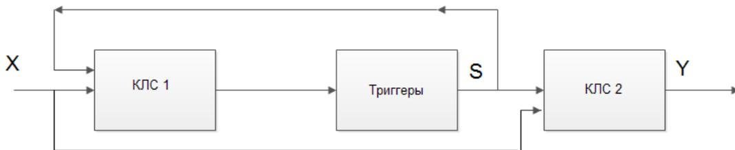
Состояние ПЛС определяется общим состоянием всех триггеров. ПЛС с  $n$  триггерами может иметь до  $2^n$  состояний.
