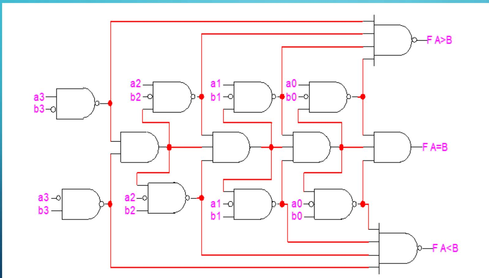
Интегральная схема 4-битного параллельного комплексного компаратора 74-85:
