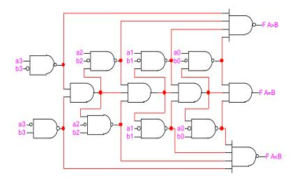
Интегральная схема 4-битного параллельного комплексного компаратора 74-85:
