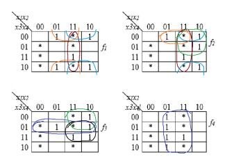
В результате минимизации были получены следующие логические функции:  $f_1=x_1\overline{x}_4\vee x_2\overline{x}_4\vee x_1x_2;$
