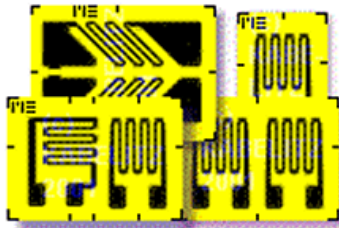
Figura 3.13. Aspecte ale tensometrelor
